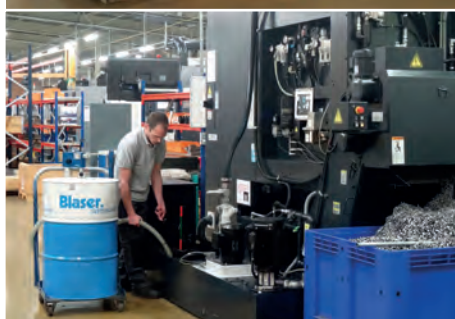
► Des ajouts de Vasco 6000 programmés à 1% et une consommation de lubrifiant réduite de 60%
