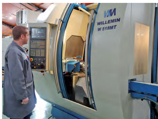
Des travaux d'une grande finesse sont réalisés sur ce centre d'usinage avec l'huile entière Vascomill 22 CSF
