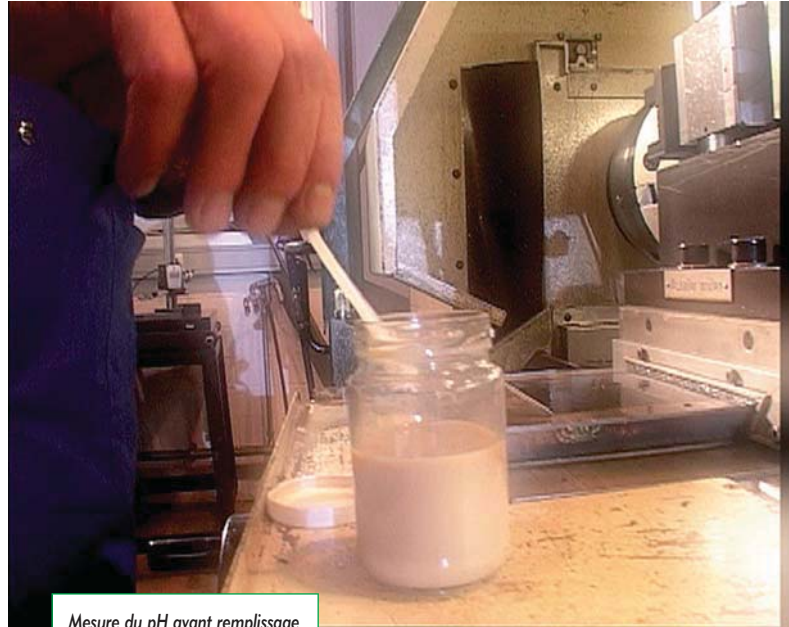
Mesure du pH avant remplissage du bac à son maximum
