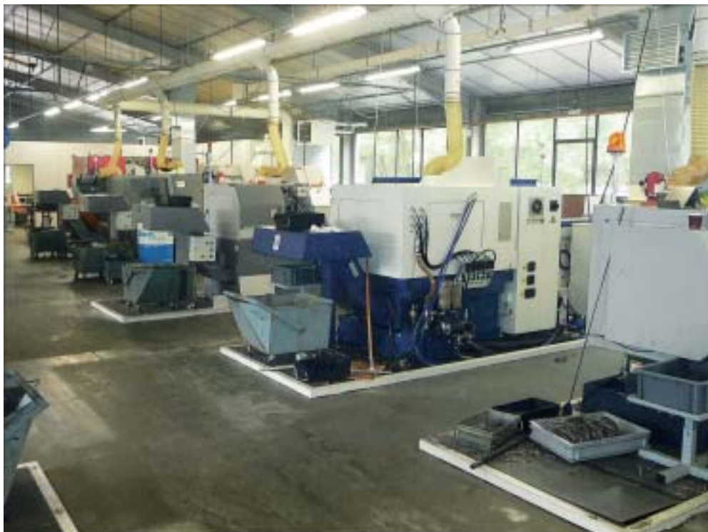
L'entreprise de BPM Décolletage dispose d'un parc de machines multiaxes à em-barreur optimisé et rationalisé autour de la marque Citizen.
