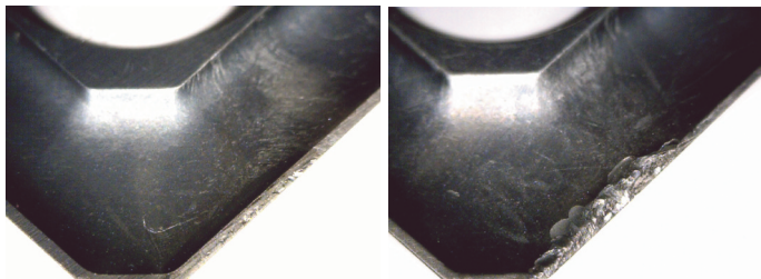
>> La macrographie montre l'usure de la plaquette lubrifiée avec Vasco 7000 après 150 minutes d'usinage – La plaquette détériorée résulte d'une usure constatée après 120 minutes avec le meilleur des lubrifiants précédemment sélectionné par Ingersoll Machine Tools
